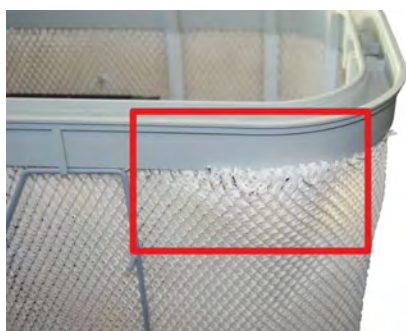
Pilt 10: Valesti paigaldatud filter
