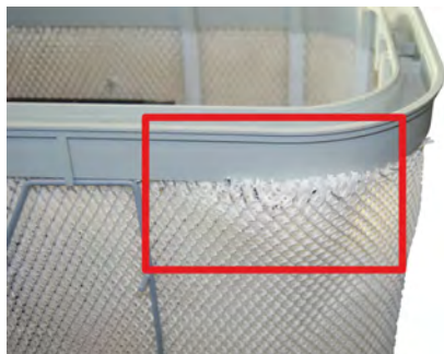
Pilt 30: Valesti paigaldatud filter
